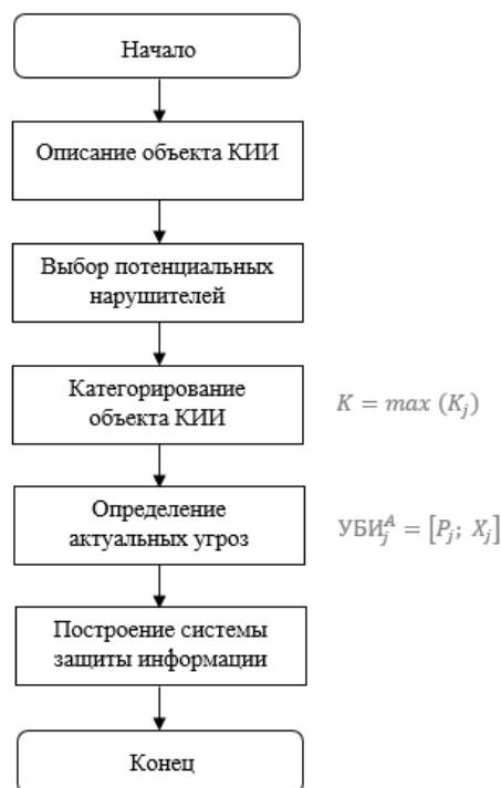
Рисунок 3 – Алгоритм по разработке модели нарушителя и угроз безопасности информации объекта КИИ
