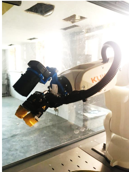
Рисунок 7 – Внешний вид захвата манипулятора с захваченным объектом
