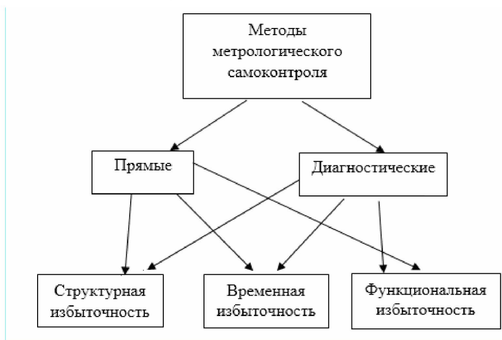
Рис. 4. Классификация методов метрологического самоконтроля интеллектуальных датчиков по ГОСТ Р 8.734-2011
