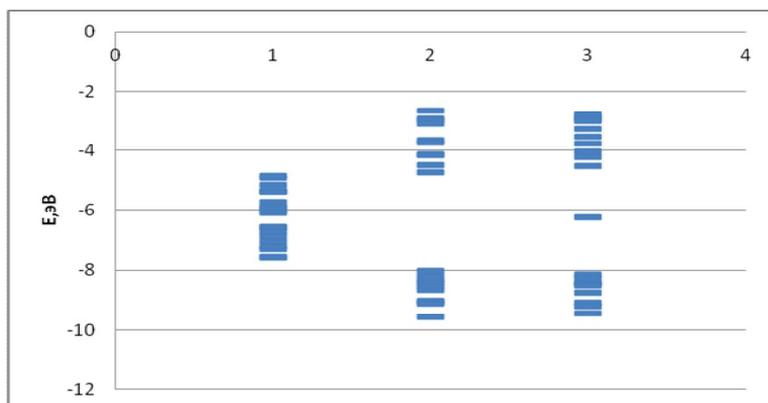
Рис. 3. Одноэлектронные энергетические спектры (6,0)  $BC_3$  нанотрубки типа В: 1 – структура без дефекта; 2 – структура с  $V_C$  дефектом; 3 – структура с  $V_B$  дефектом
