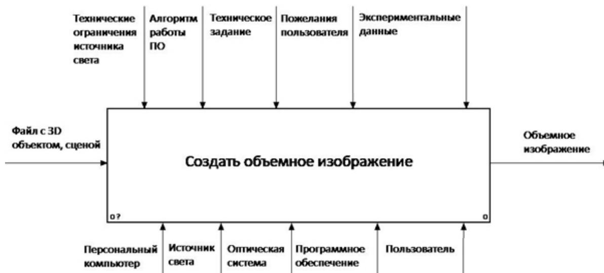
Рисунок 8 – Функциональное моделирование процесса создания объемного изображения (0 уровень)
