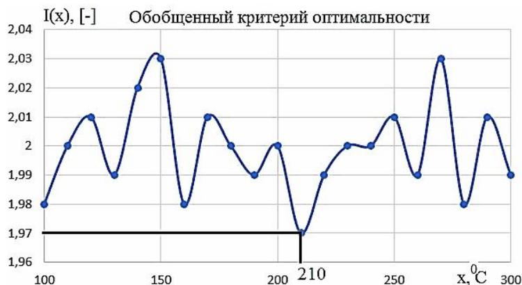
Рис. 1. Зависимость ОКО от температуры на выходе из печи риформинга
