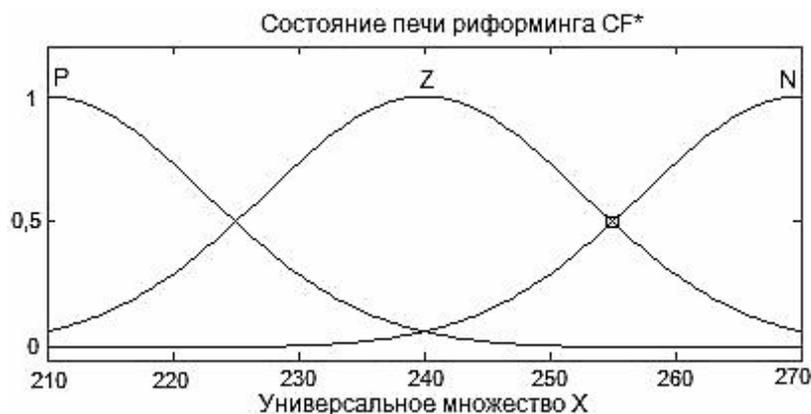
Рис. 3. График функции принадлежности ЛП «Состояние печи риформинга» для процесса КР
