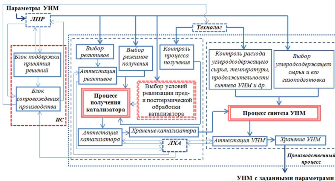
Рисунок 2 – Структура ТС промышленного производства УНМ
