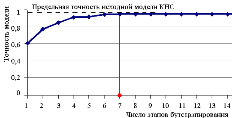
Рисунок 10 – Влияние числа этапов бутстрэпирования на точность модели КНС
