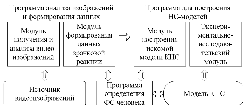
Рисунок 9 – Структура инструментального комплекса программ
