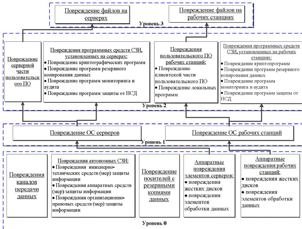
Рисунок 3 – Иерархия возможных повреждений ИС ФП
